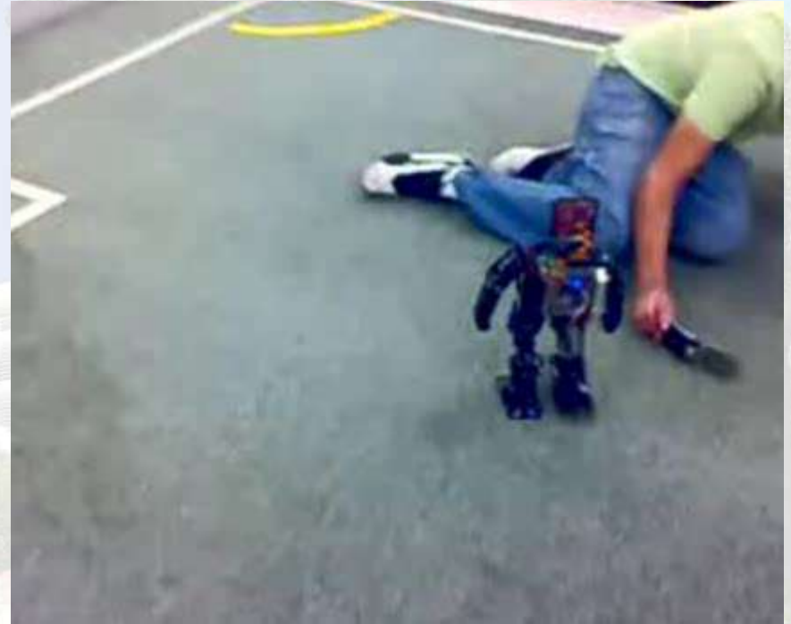
Caminado dinámicamente estable (con ZMP)
